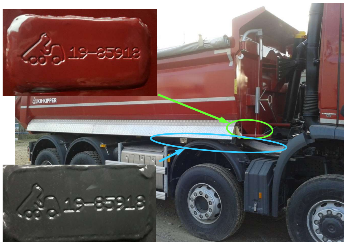
Рис. 5. Пример размещения паспортной таблички серийного номера на кузове и промежуточной раме
