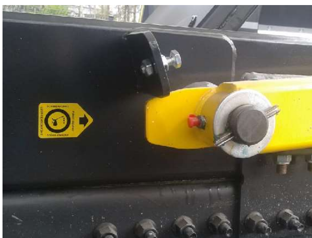
Рис. 28. Точки смазки стабилизатора и ремонтного (страховочного) упора.
