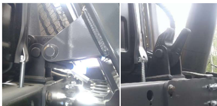
Рис. 48. Замок НУFIX а – закрытый, б - открытый
