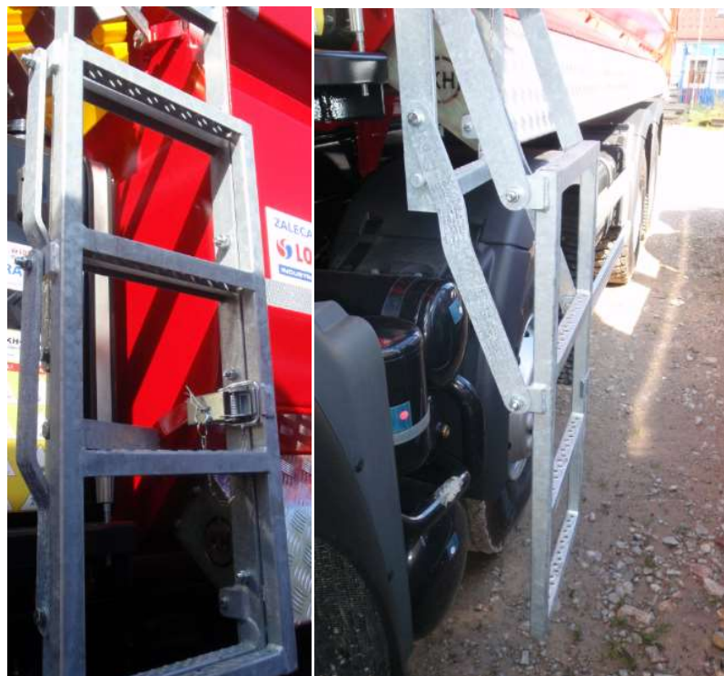
Рис.31. Лестница на передней стенке.
