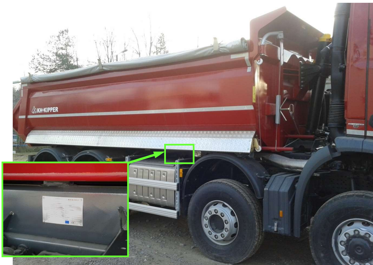
Рис. 4. Пример размещения паспортной таблички
