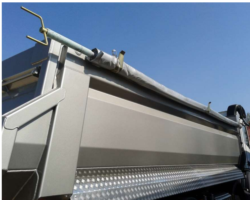
Рис. 30. Тент: а) сворачиваемый на переднюю стенку, б) сворачиваемый на боковой борт
