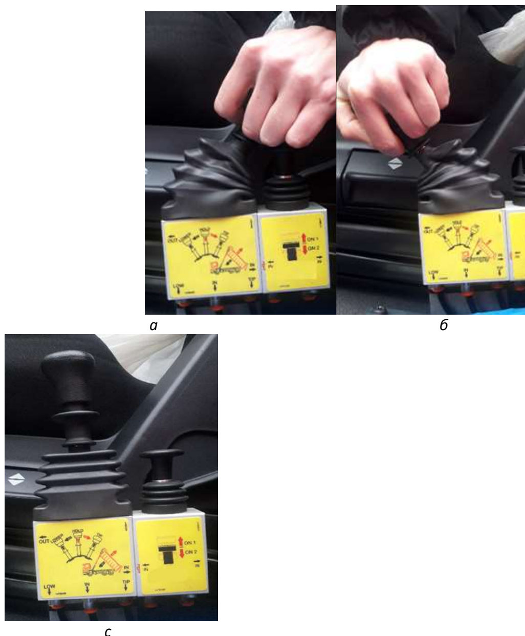
Рис. 12. Пневматический клапан, контролирующий подъем и опускание кузова: а) поднятие кузова, б) опускание кузова, с) нейтральное положение
