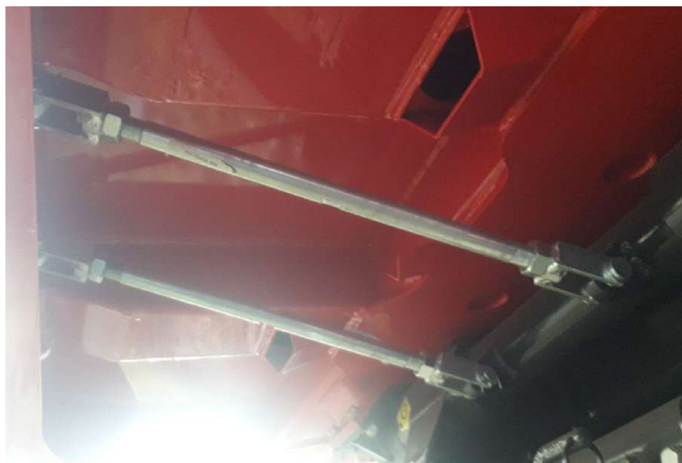
Рис. 14. Пример тяг открытия / закрытия заднего борта
