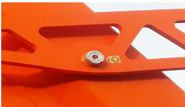
Рис. 26. Точки смазки пальцев заднего борта W1M, W1MV
