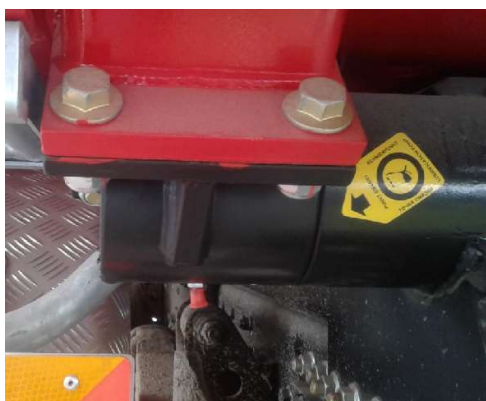
Рис. 23. Точки смазки для нижних креплений цилиндров
