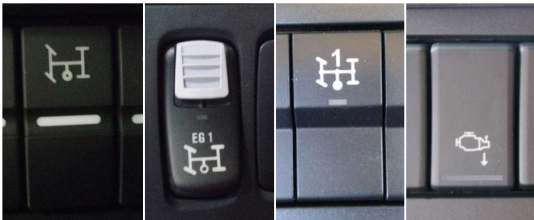
Рис. 13. Примеры переключателей отбора мощности и символов
