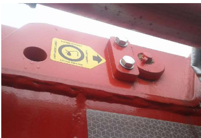
Рис. 25. Точки смазки шарнира заднего борта
