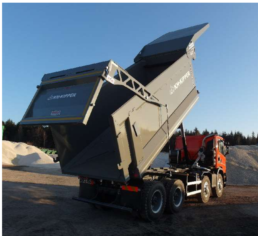
Рис.15 Задний борт открыт удерживаемый тросами
