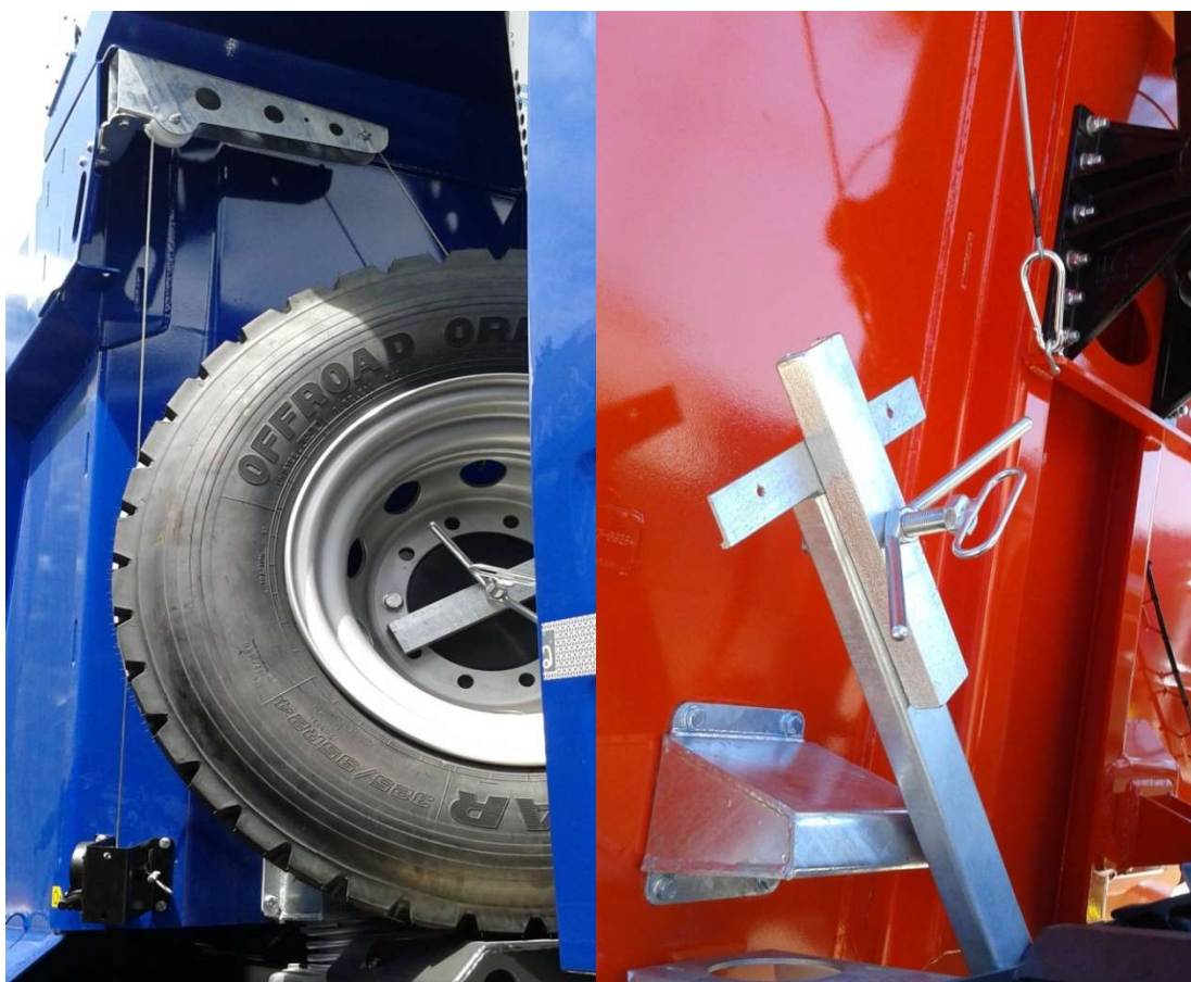
Рис. 28 Крепление запасного колеса на консоли. Кронштейн запасного колеса с гайкой и болтом. Место крепления для троса лебедки.
