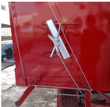
Рис. 29. Пример предохранения троса запасного колеса.
