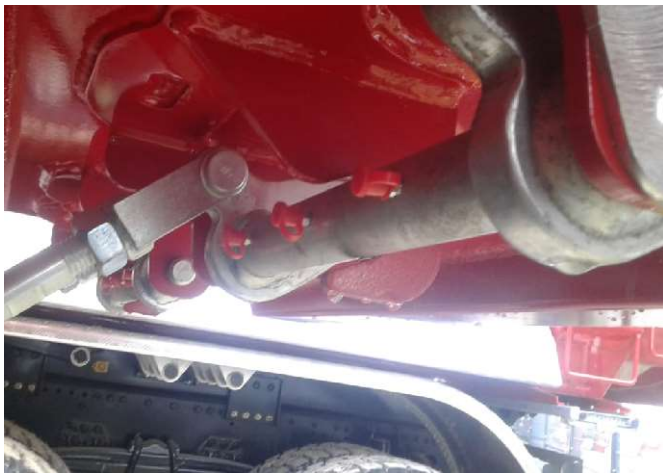
Рис. 27. Точки смазки замков заднего борта
