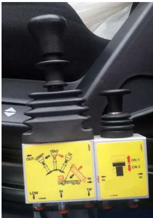
Рис. 11 Пример пневматического контроллера поднятия кузова с контроллером для управления гидравлическим бортом
